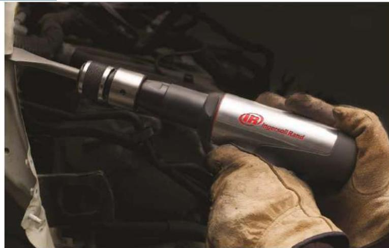
Os martelos pneumáticos Ingersoll Rand foram projetados para permitir que a ferramenta faça o trabalho, **seja cortando, perfurando, lascando ou raspando**. Cada martelo pneumático é fornecido com um retentor de mola helicoidal para mudanças rápidas e fáceis do cinzel. Você também pode comprar um cinzel de cinco peças ou adquirir um kit de martelo pneumático Ingersoll Rand, que inclui o martelo e o cinzel.
